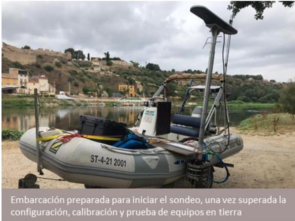
Figura 3. Embarcación “Eutrona” preparada para el trabajo batimétrico en Mora de Ebro
