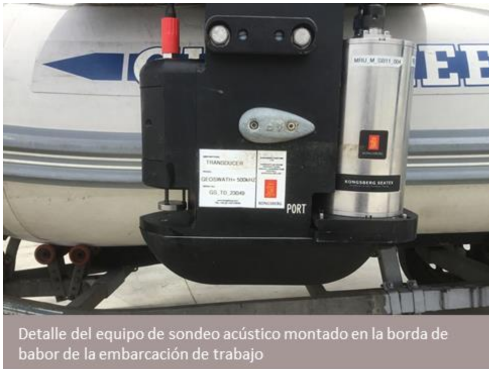
Figura 5. Ecosonda multihaz una vez montada en la borda de la embarcación
